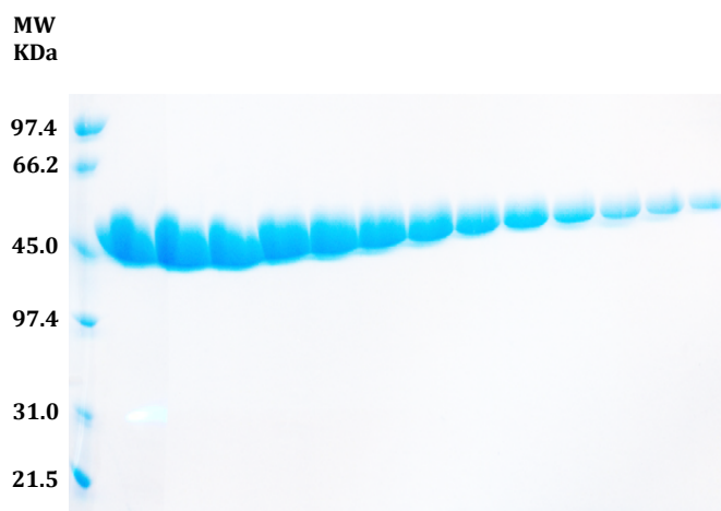
Figura 7. PAGE-SDS de purificación de BsFtsZ. Se cargan las muestras de las fracciones recogidas después de la cromatografía de interacción hidrofóbica.
